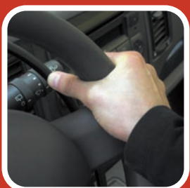
C. Den Gasring mit dem Daumen innerhalb des Lenkrads drücken
